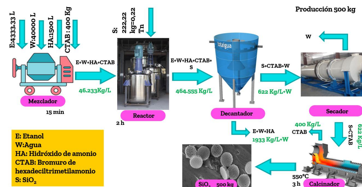
Figura 3. Producción de nanopartículas de sílice mesoporosa a escala semipiloto
